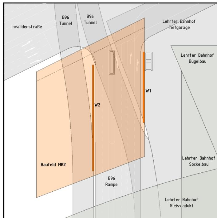
Abb. I.21 X-Ray: Baufeld MK2 mit unterirdischen Bauwerken
